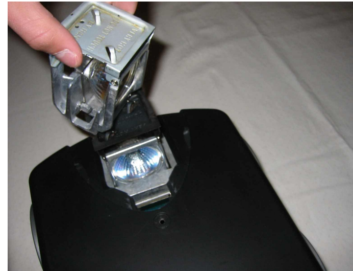
Figura 2. Removiendo la vieja lámpara
