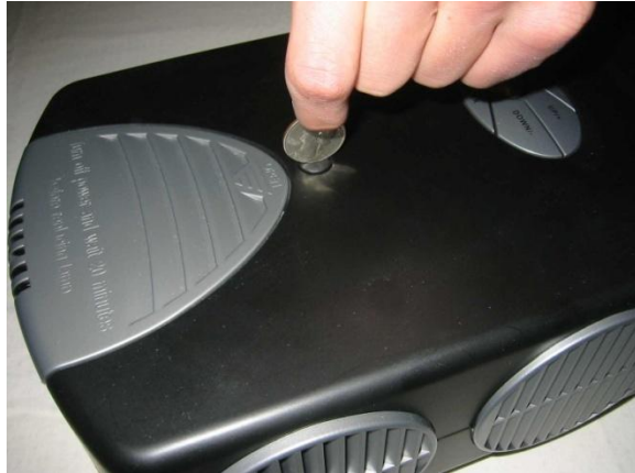
Figura 1. Removiendo la cubierta de la lámpara
